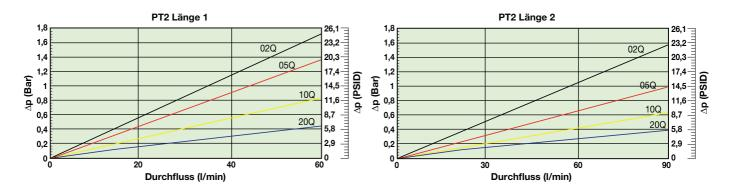
Druckabfall für Filter und Element bei einer Viskosität von 30 mm²/s und einer Dichte von 0,87.
