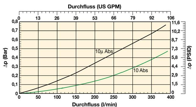
Druckabfall für Filter und Element bei einer Viskosität von 30 mm<sup>2</sup>/s und einer Dichte von 0,856.
